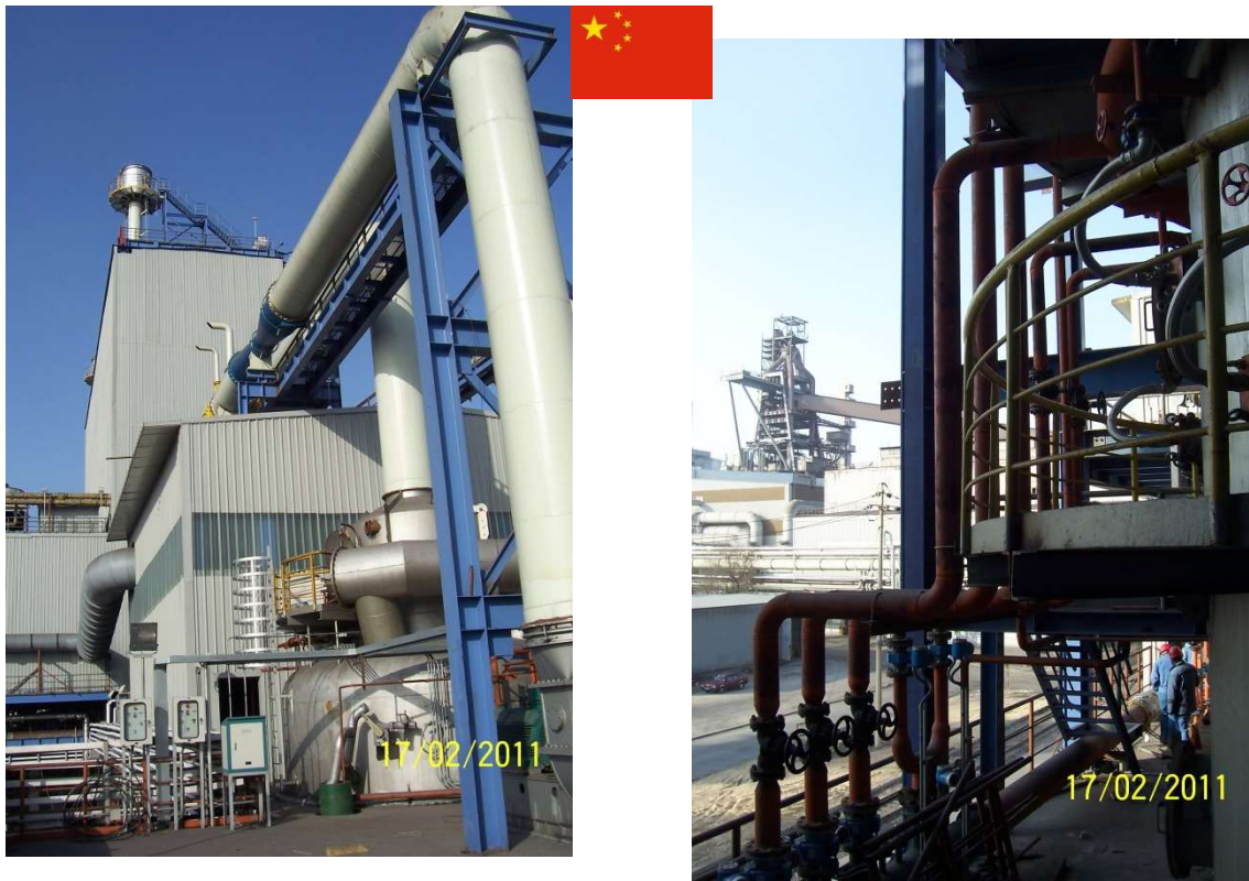
Forno de Cuba GCP (resíduos de processamento de produção de aço inoxidável) em Taiyuan (China)
