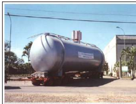
Recipiente para Hidrocarburos - OS: 21.604/2.003 Øi 4.500 X 18.281 mm - Peso: 43,0 Ton
