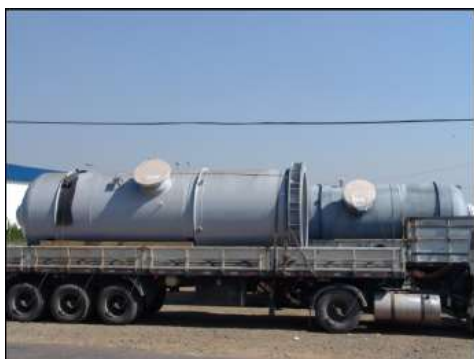
Reactor Separador nr.º 3 - OS: 24.008/2.007 \varnothing i 2.250 X 7.905 mm - Peso: 20,1 Ton
