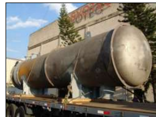
Intercambiador de Carga de Fondo – BEU – 1.141 M 2 PB/RPBC/SP – Unidad de Hidrotatamiento UT / HTD OS: 23.790/2.006 Øi 1.610 X 8.260 mm - Peso: 29,0 Ton. Material: SA-516 Gr.60 /SA-268 TP405/SA-105+CLAD 410 S
