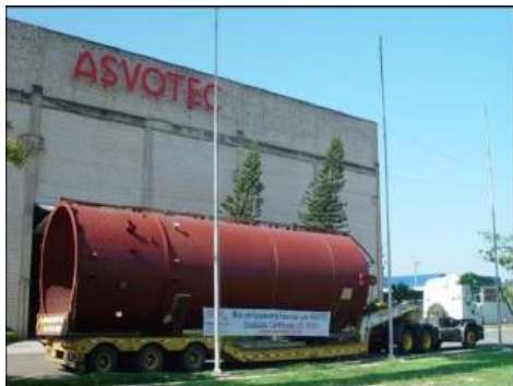
Filtro para Diesel (Salt) Tag. nr.º G-908-C PB/RLAM/Mataripe/BA ASME Sec.VIII-DIV.1 Ed. 2001 Ad. 2003 OS: 22.577/2.004 - Øi 3.446 X 13.445 mm - Peso: 44,8 Ton Material: SA-516 Gr.70
