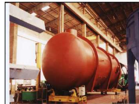
Recipiente Fraccionador de Reflujo OS: 22.000/2.004 Øi 4.000 x 16.000 mm – Peso: 34,0 Ton
