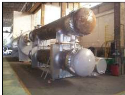
Enfriador Debutanizador de Gasolina – AES – 452 M 2 PB/REDUC/RJ – Revamping de Unidad UFCC (U1250) OS: 21.643/2.003 Øi 1.105 X 7.365 mm - Peso: 15,8 Ton. Material: SA-516 Gr.60 /SA-179/SA-105
