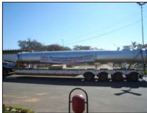
Condensador Depropanizador – AEM – 2.042 M 2 PB/REVAP/S Unidad de Producción de Propileno U-280 OS: 24.149/2.007 Øi 1.450 X 14.530 mm - Peso: 45,0 Ton. Material: SA-516 Gr.60 /SA-179/SA-516 Gr.70/SA-105
