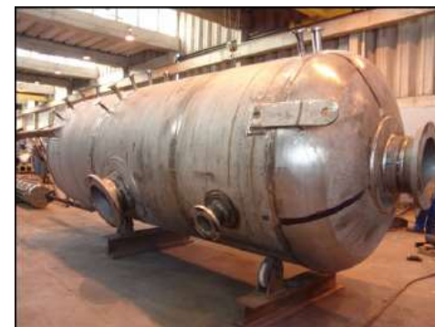
Recipiente de Succión del Compresor OS: 24.045/2.00 \varnothing i 1.700 X 6.245 mm - Peso: 3,6 Ton
