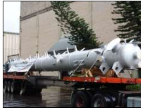
Torre Regenerativa + Bandejas+ Escaleras y Plataformas - ASME Sec.VIII-DIV.1 - OS: 24.063/2.007 \varnothing i 1.000 X 18.636 mm - Peso: 13,5 Ton. Material: SA-240-304L/SA-240-316L
