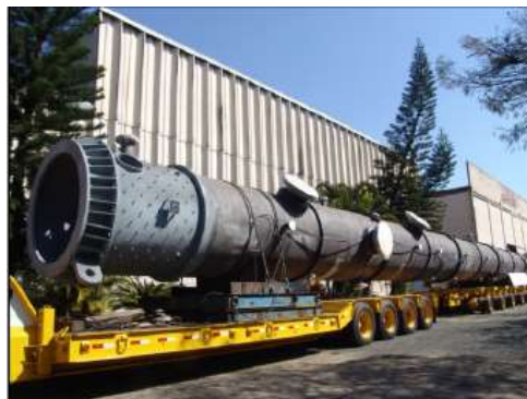
Reactor de Alquilerón - OS: 24.082/2.007 \varnothing i 2 000 x 32.550 mm - Peso: 98,3 Ton
