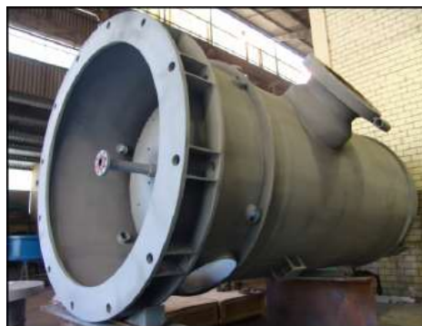
Vaporizador de Reflujo - OS: 24.009/2.007 \varnothing i 2.000 X 5.475 mm - Peso: 14,6 Ton
