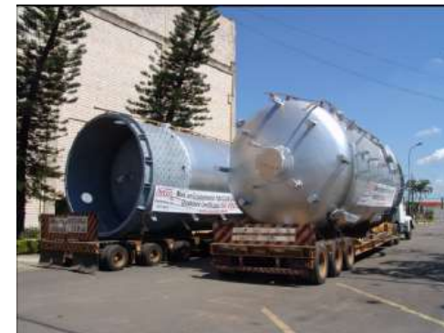
Filtro Desalador - OS: 24.094/2.007 \varnothing i 3.950 X 10.040 mm - Peso: 32,5 Ton
