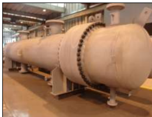
Rehervidor Frontal H 2 S – BHU – 411 M 2 PB/RPBC/SP – Unidad de Reforma Catalítica (URC) OS: 25.452/2.009 Øi 1.100 X 8.083 mm - Peso: 25,5 Ton. Material: SA-516 Gr.70 /SA-179/SA-105 N
