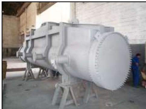
Pre-Condensador de Sistema de Vacío – CXN – 224 M 2 PB/RPBC/SP Unidad de Hidrotratamiento Inestable U-22313 OS: 22.427/2.004 Øi 1.143 X 6.932 mm – Peso: 16,0 Ton. Material: SA-516 Gr.60 /SA-179/SA-516 Gr. 70/SA-105
