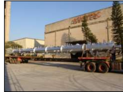
Torre de Absorción + Bandejas+ Escaleras y Plataformas - ASME Sec.VIII-DIV.1 - OS: 25.721/2.010 \varnothing i 915 X 24.900 mm - Peso: 21,7 Ton. Material: SA-516 Gr.70 (B Class H2S)
