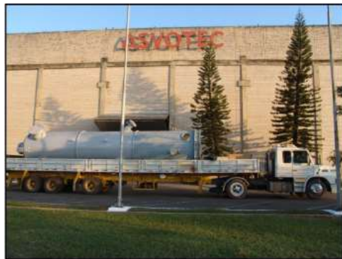
Filtro de Etileno - OS: 24.086/2.007 \varnothing i 2.000 X 11.935 mm - Peso: 26,5 Ton
