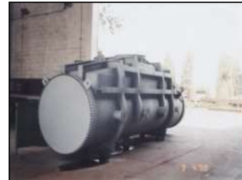
Intercondensador de Sistema de Vacío – CXN – 641 M 2 PB/RPBC/SP Unidad de Hidrotratamiento Inestable U-22313 OS: 22.428/2.004 Øi 1.676 X 7.126 mm – Peso: 31,4 Ton. Material: SA-516 Gr.60 /SA-179/SA-516 Gr. 70/SA-105
