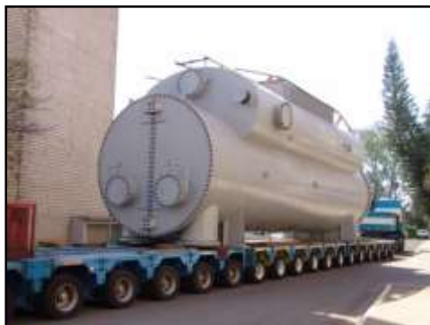
Condensador de Superficie – CXN – 5.959 M 2 SIEMENS - PB/RFAP/ Generador de Energia OS: 26.471/2.010 Øi 3.700 X H 5.350 X 14.741 mm - Peso: 152,0 Ton. Material: SA-285 Gr.C /SB-111-C44300/SA-516 Gr. 70/SA-105
