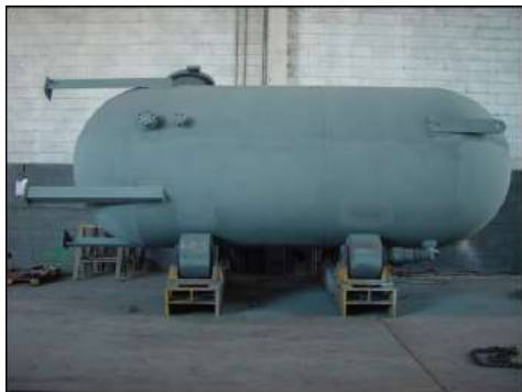
Tanque Pulmon para Nitrogeno - OS: 23.787/2.006 \varnothing i 2 200 x 6.400 mm – Peso: 10,3 Ton
