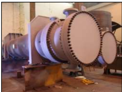
Intercambiador de Calor – AES – 492 M 2 PB/RPBC/SP – UNA 25 Unit (URC) OS: 24.421/2.007 Øi 1.143 X 7.500 mm - Peso: 19,6 Ton. Material: SA-516 Gr.60 /SA-179/SA-516 Gr.70/SA-105
