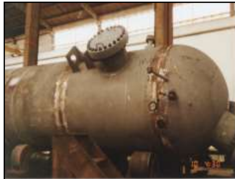
Enfriador de Catalizador – Bayoneta – 188 M 2 PB/RECAP/SP Unidad de Craqueo Catalítico U-570 OS: 20.965/2.001 Øi 2.179 X 14.375 mm – Peso: 61,7Ton. Material: SA-516 Gr.60 /SA-213 T11/SA-179/SA-266
