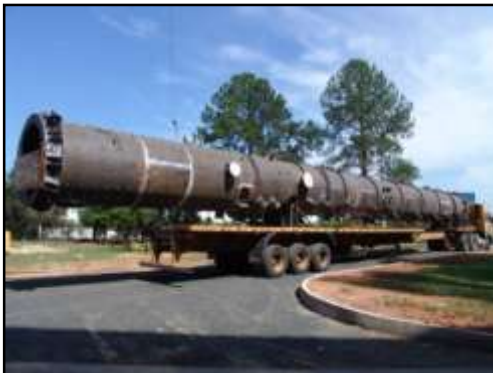
Torre de Fraccionamiento + Bandejas + Escaleras y Plataformas - ASME Sec.VIII-DIV.1 - OS: 25.469/2.009 \varnothing i 1.900 X 29.241 mm - Peso: 25,5 Ton. Material: SA-516 Gr.70
