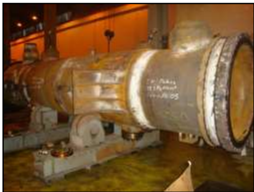
Caldeira de Recuperación de Calor – NEN – 216 M 2 PB/FAFEN/Laranjeiras/SE Unidad de Producción de Amoniaco OS: 23.865/2.006 - Øi 1.194 X 7.620 mm - Peso: 31,6 Ton. Material: SA-516 Gr.70 /SA-213-Gr. T11/SA-182-Gr.11-CL.2
