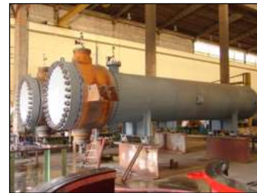
Precalentador – DFU – 649 M 2 PB/RPBC/SP Unidad de Hidrotatamiento UT / HTD OS: 23.992/2.006 Øi 1.321 X 7.984 mm - Peso: 25,5 Ton. Material: SA-516 Gr.60 /SA-268 TP405/SA-266 Gr. 4/SA-105
