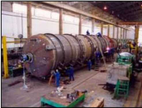
Torre de Pre Vacío+ Bandejas+Escaleras y Plataformas - ASME Sec.VIII-DIV.1 - OS: 21.000/2.002 \varnothing i 4.500 X 31.040 mm - Peso: 117,0 Ton. Material: SA-516 Gr.60 + SA-240-317L (CLAD)
