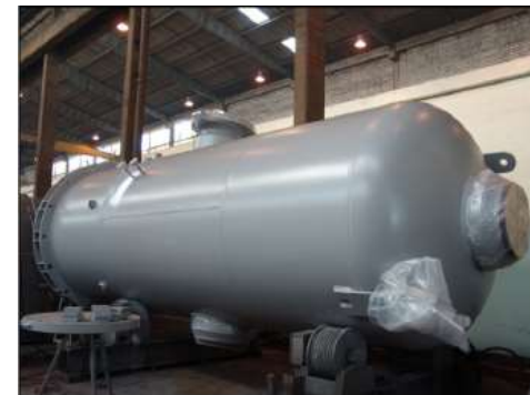
Reactor Separador nr.º 2 - OS: 24.007/2.007 \varnothing i 2 200 x 6.825 mm – Peso: 18,0 Ton
