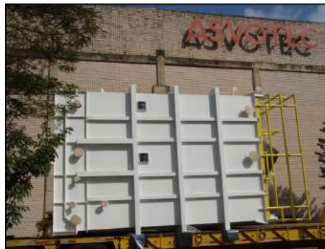
Tanque Deodulante de Diluyente - OS: 23.966/2.006 2.500 X 3.002 X 6.251 mm - Peso: 7,4 Ton
