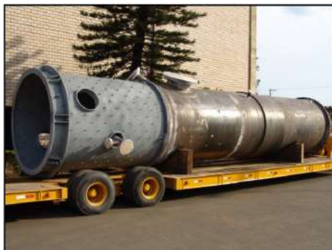
Filtro de Benceno - OS: 24.084/2.007 \varnothing i 2.000 x 11.665 mm - Peso: 14,0 Ton
