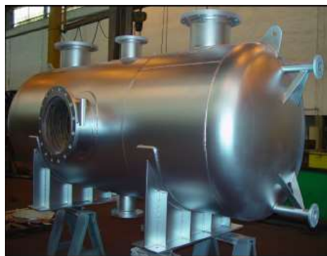
Recipiente Separador del Sistema de Antorcha OS: 22.812/2.004 Øi 1.250 X 3.847 mm - Peso: 2,3 Ton
