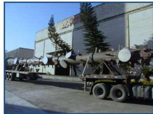
Torre de Desobrecalentamiento + Bandejas + Escaleras y Plataformas - ASME Sec.VIII-DIV.1 - OS: 25.720/2.010 \varnothing i 915 X 22.650 mm - Peso: 21,0 Ton. Material: SA-516 Gr.70 (B Class H2S)
