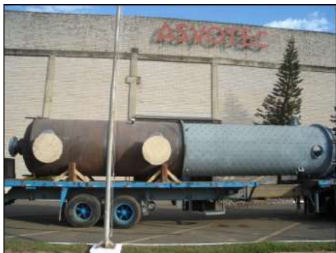
Reactor - OS: 24.081/2.007 \varnothing i 2 000 x 12.925 mm - Peso: 24,8 Ton
