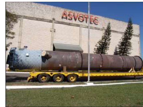
Reactor de Translocacion OS: 24.083/2.007 \varnothing i 1 900 x 16.920 mm - Peso: 34,1 Ton
