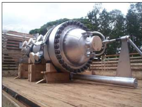
Recipiente de Separación de Prueba OS: 22.807/2.004 Øi 660 X 2.952 mm - Peso: 4,3 Ton
