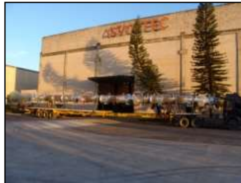
Torre Regenerativa + Bandejas + Escaleras y Plataformas - ASME Sec.VIII-DIV.1 - OS: 25.722/2.010 \varnothing i 915 X 33.050 mm - Peso: 29,6 Ton. Material: SA-516 Gr.70 + SA-240-316L (CLAD)
