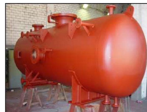
Recipiente "Liquid Front Ampoule" OS: 22.814/2.004 Øi 1.492 X 4.784 mm - Peso: 4,3 Ton
