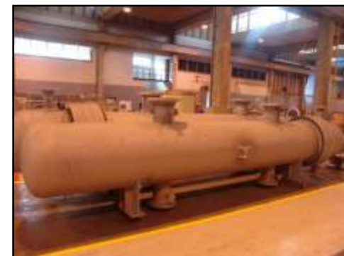
Rehervidor Estabilizador – BHU – 368 M 2 PB/RPBC/SP – Unidad de Reforma Catalítica (URC) OS: 25.451/2.009 Øi 1.025 X 8.008 mm - Peso: 15,4 Ton. Material: SA-516 Gr.70 /SA-179/SA-105 N
