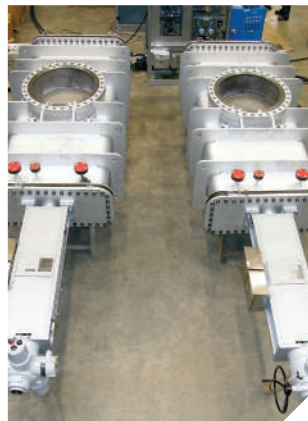
Válvula conduíte Conduit valve
