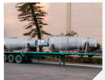
Ciclone para UFCC FCCU Cyclone
