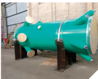
Riser para UFCC Riser FCCU
